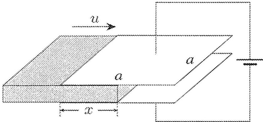
一辺の長さが  $a$  の正方形の極板を使った電気容量  $C$  の平行板コンデンサーがある。電圧  $V$  の電池に接続されている極板間には、同形で同じ厚さの比誘電率が  $4$  の誘電体が挿入できるようになっている。極板間隔は  $a$  に比べて十分小さいものとする。
