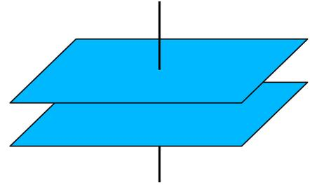
① になる。よって、極板間に生じる電界は ② [V/m] である。よって、極板間の電圧 (電位差) は ③ になるので、このコンデンサーの電気容量は ④ と表すことができる。
