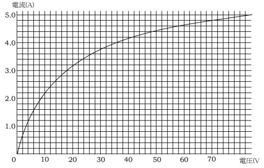
次に、もっと明るく点灯させるため、電池を2個使うことにした。電池2個を並列にして電球を点灯させてみた。このときは、最初のときより随分明るく点灯したように見えた。このときの電球の消費電力は 4 [W] であった。
