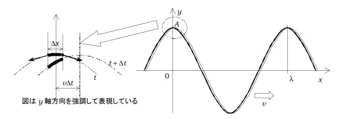
弦の線密度が  $\rho$  [kg/m]、弦の張力が S [N] の弦を伝わる波がある。この波の波長は  $\lambda$  [m]、振幅は A [m]、弦を伝わる波の速さは v [m/s] である。上の図に示すように、時刻 t [s] の波が太線で示す位置におり、このとき、x=0 の位置に変位が正に最大である。この波が、時刻  $t+\Delta t$  [s] のときに細線の位置に移動した。このときの時間  $\Delta t$  [s] の間に、弦の微小部分がどのように動いたかを考えてみることで、弦を伝わる波の速さの公式が  $v=\sqrt{\frac{S}{\rho}}$  になることを導いいてみよう。ただし、このとき、 $\Delta t$  は十分に短い時間を表し、x がゼロに近いとき、 $\sin x \simeq x$ 、 $\cos x \simeq 1-\frac{1}{2}x^2$  、 $\tan x \simeq \sin x$  の近似式が成立する。
